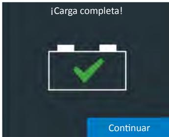
7. Mientras se muestra esta pantalla, el cargador continúa cargando la batería en segundo plano hasta alcanzar su capacidad máxima. El cargador continuará haciendo esto hasta que la aceptación de la carga de la batería esté al 100 %.
