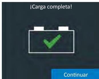
4. Mientras se muestra esta pantalla, el cargador continúa cargando la batería en segundo plano hasta alcanzar su capacidad máxima. El cargador continuará haciendo esto hasta que la aceptación de la carga de la batería esté al 100 %.
