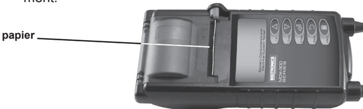
**REMARQUE :** Pour que le papier se déchire proprement, tirez dessus en suivant le bord du plastique. Ne tirez pas sur le papier en le dirigeant vers l'extérieur de l'imprimante.
