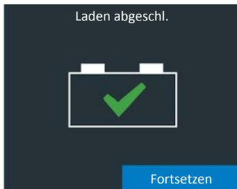
7. Während dieser Bildschirm angezeigt wird, lädt das Ladegerät die Batterie im Hintergrund weiter bis zur maximalen Kapazität (Schlussspannung) auf. Das Ladegerät setzt den Ladevorgang fort, bis die Ladungsaufnahme der Batterie 100% beträgt.
