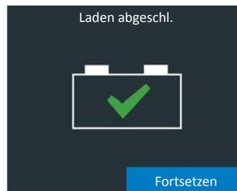
4. Während dieser Bildschirm angezeigt wird, lädt das Ladegerät die Batterie im Hintergrund weiter bis zur maximalen Kapazität (Schlussspannung) auf. Das Ladegerät setzt den Ladevorgang fort, bis die Ladungsaufnahme der Batterie 100% beträgt.
