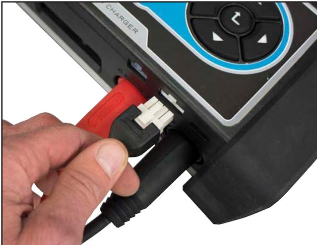
3. Der Anschlussvorgang ist komplett, wenn alle drei Kabel an das Ladegerät angeschlossen sind.
