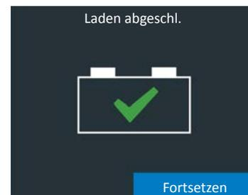
Während dieser Bildschirm angezeigt wird, lädt das Ladegerät die Batterie im Hintergrund weiter bis zur maximalen Kapazität (Schlussspannung) auf. Das Ladegerät setzt den Ladevorgang fort, bis die Ladungsaufnahme der Batterie 100% beträgt.
