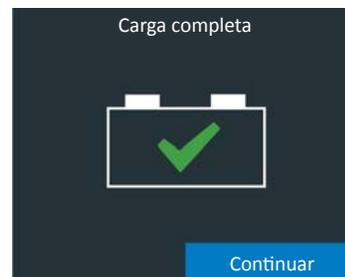
4. Mientras se muestre esta pantalla, el cargador seguirá cargando la batería en segundo plano hasta su capacidad máxima. El cargador seguirá cargando hasta que la aceptación de la batería de la carga sea del 100 %.
