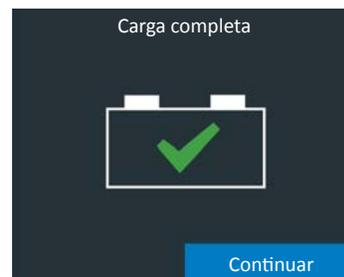
Mientras se muestre esta pantalla, el cargador seguirá cargando la batería en segundo plano hasta su capacidad máxima. El cargador seguirá cargando hasta que la aceptación de la batería de la carga sea del 100 %.
