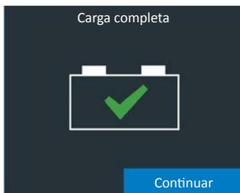
7. Mientras se muestre esta pantalla, el cargador seguirá cargando la batería en segundo plano hasta su capacidad máxima. El cargador seguirá cargando hasta que la aceptación de la batería de la carga sea del 100 %.
