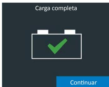
8. Mientras se muestre esta pantalla, el cargador seguirá cargando la batería en segundo plano hasta su capacidad máxima. El cargador seguirá cargando hasta que la aceptación de la batería de la carga sea del 100 %.
