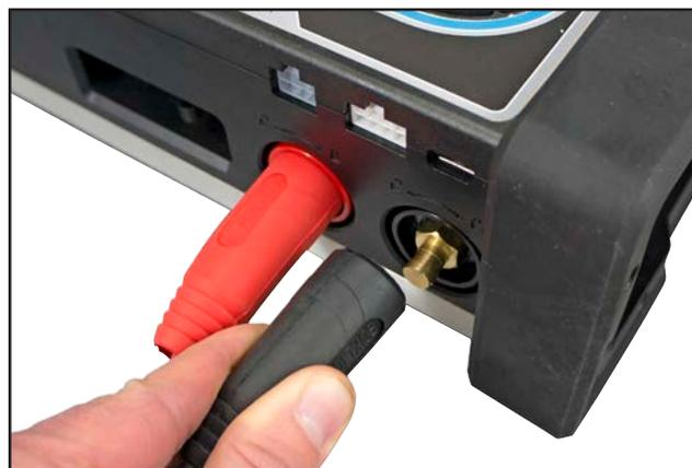
2. Inserte del conector de control.
