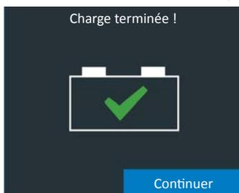
7. Pendant l'affichage de cet écran, le chargeur continue le chargement de la batterie en arrière-plan, pour la remplir jusqu'à sa capacité maximale. Le chargeur continuera le chargement jusqu'à ce que l'acceptation de charge de la batterie atteigne 100 %.
