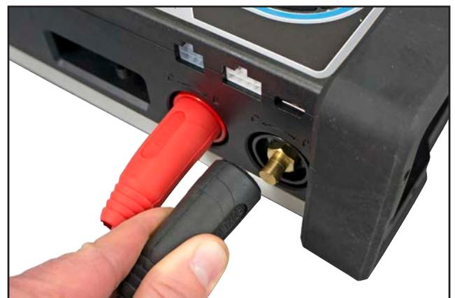
2. Insérez le connecteur de commande.
