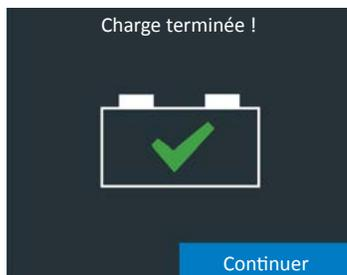
8. Pendant l'affichage de cet écran, le chargeur continue le chargement de la batterie en arrière-plan, pour la remplir jusqu'à sa capacité maximale. Le chargeur continuera le chargement jusqu'à ce que l'acceptation de charge de la batterie atteigne 100 %.
