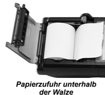
3. Schließen Sie die Klappe, und stellen Sie sicher, dass der Hebel sicher einrastet.
