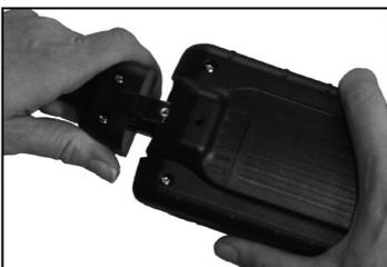
4. Um ein neues Kabel zu befestigen, richten Sie das Kabel und das Gehäuse des Testgeräts aus und drücken Sie beides zusammen. Setzen Sie die Schraube ein und ziehen Sie sie fest.
