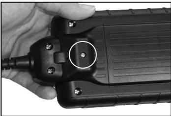
2. Entfernen Sie die Schraube.
