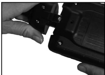
4. Per collegare un nuovo cavo, allineare gli alloggiamenti del cavo e del tester e spingere contemporaneamente. Reinserire e serrare la vite.
