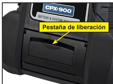
2. Levante la tapa de la impresora y extraiga el rollo gastado.
