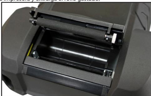
3. Coloque el rollo de papel nuevo en el compartimento. El papel se alimenta por la parte inferior del rollo.
