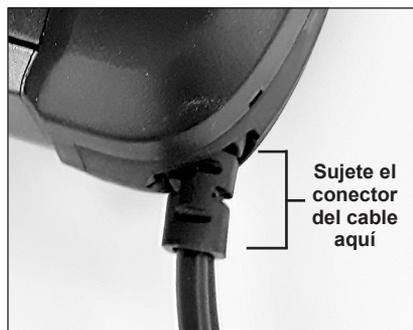
Para evitar daños en el cable de prueba de la batería, sujete siempre la parte superior del conector del cable (como se muestra en la fotografía) al insertar y retirar el cable.
