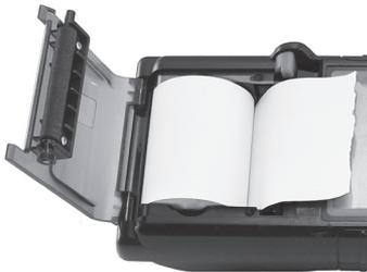
**Papier wird von unter der Rolle zugeführt**
