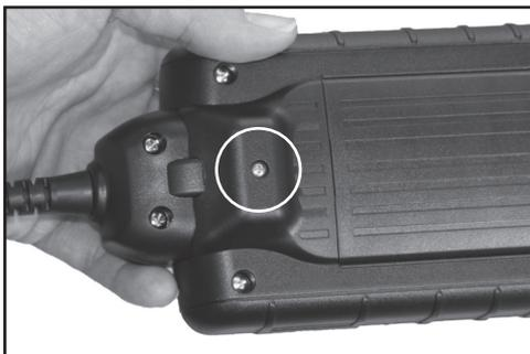
2. Lösen Sie die Schraube.
