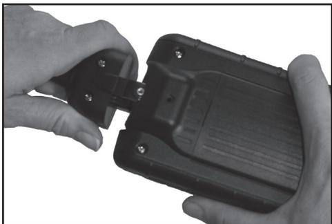
4. Per collegare un nuovo cavo, allineare gli alloggiamenti del cavo e del tester e spingere contemporaneamente. Reinscrivere e serrare la vite.
