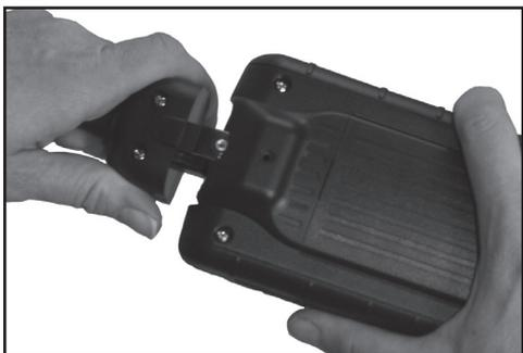
4. Para conectar un cable nuevo, alinee la carcasa del cable y del comprobador y empújelos el uno contra el otro. Introduzca el tornillo y apriételo.
