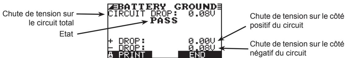
Figure 18 : Résultat des tests de la batterie à la terre = PASSER
