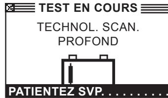
Après l'analyse approfondie, le testeur affichera les résultats ou vous permettra d'effectuer le test de réponse dynamique de 5 minutes. Bien que ce test prenne plusieurs minutes, il donne un résultat plus précis pour les batteries dont le diagnostic est difficile. L'organigramme du test est illustré ci-après.
