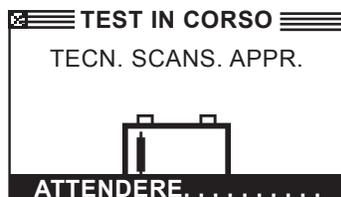
Al termine, il tester visualizzerà i risultati oppure consentirà di eseguire il test di risposta dinamica di 5 minuti. Benché l'esecuzione di questo test richieda parecchio tempo, fornisce un risultato più preciso nel caso di batterie difficilmente analizzabili. Di seguito viene mostrato il diagramma di flusso del test.
