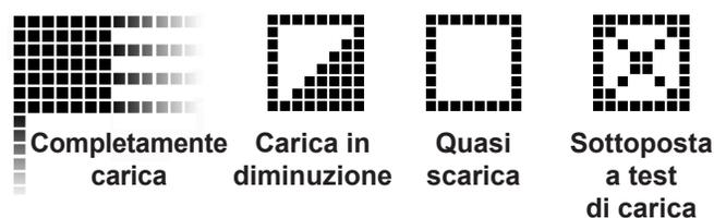
Figura 7: Indicatore del livello di carica delle batterie AA
