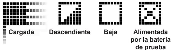
Figura 7: Indicador de nivel de alimentación de las baterías AA
